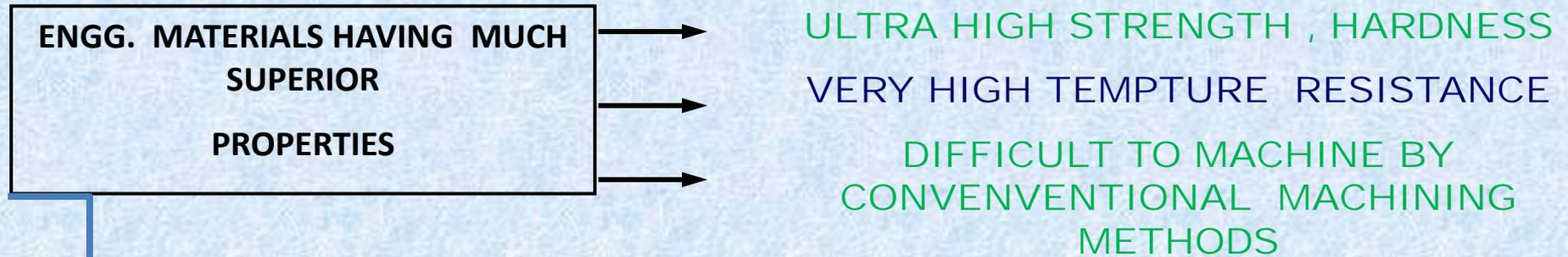
**WORK PIECE MATERIAL HARDNESS >> TOOL MATERIAL HARDNESS**
