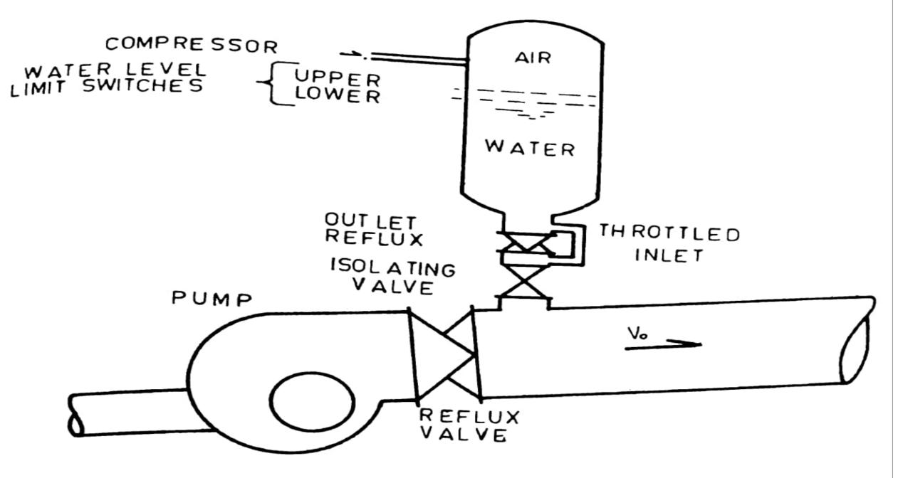
**FIGURE 6.6 : AIR VESSEL**
