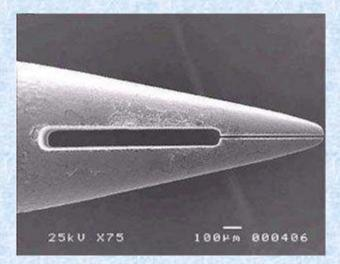
MICRO CUTTING IN A TUNGSTEN PIN USING 511nm ND LASER
