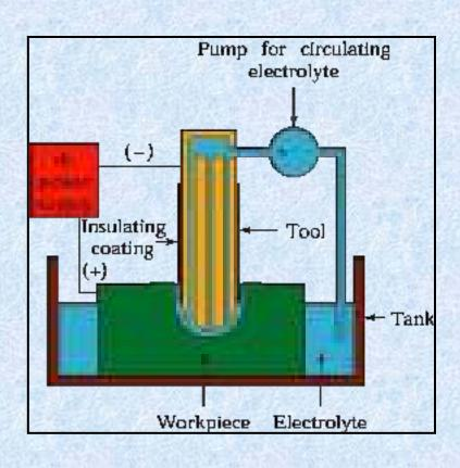
Fe +  $2H_2O$  Fe(OH)<sub>2</sub> +  $H_2$  $4Fe(OH)_2 + 2H_2O + O_2$   $4Fe(OH)_3$
